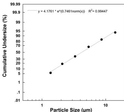
Les mesures ont été effectuées avec une solution de fluore de sodium à l'aide d'un impacteur NGI (Next Generation Impactor).
